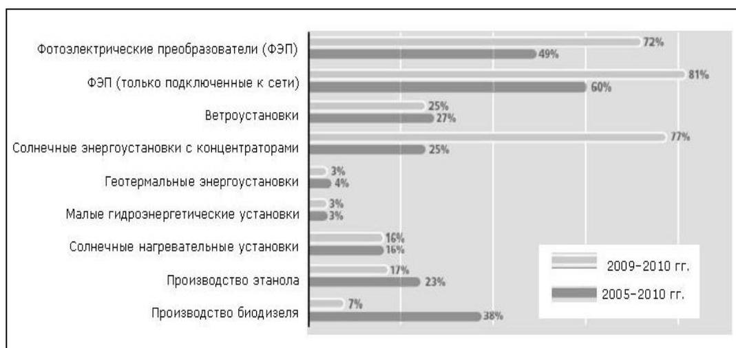
Рисунок 1– Средние годовые темпы роста мощности энергоустановок на ВИЭ и производства биотоплива в 2005–2010 гг. [2]
