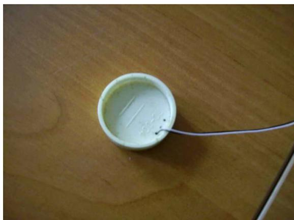
Рисунок 4 – Пьезоэлектрический акселерометр.
