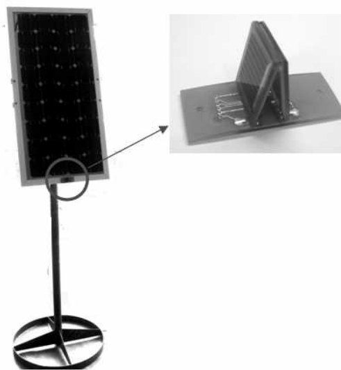
Рисунок 6 – Экспериментальный макет системы слежения
