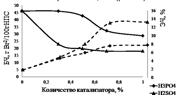
Рисунок 3 - Зависимость бромного и эпоксидного чисел от концентрации и вида катализатора ( — - бромное число, --- - эпоксидное число)
