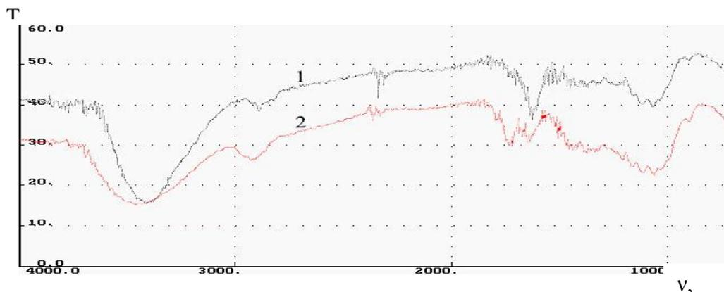
Рисунок 3 – ИК-спектр предгидролизованной древесины (1) и сукцината целлюлозы (2)
