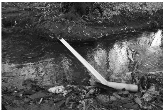
Рисунок 1 - Устройство для очистки поверхностного слоя воды на малых реках (вид сбоку)
