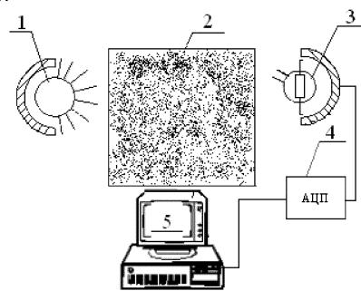
1 – источник света, 2 – камера, заполненная частицами диоксида кремния, 3 – фотодиод, 4 – аналогово-цифровой преобразователь, 5 – персональный компьютер
