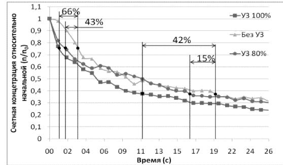
*Рисунок 7 – Зависимости относительной счётной концентрации частиц  $\text{SiO}_2$  от времени с воздушными потоками со скоростью 5 м/с.*
