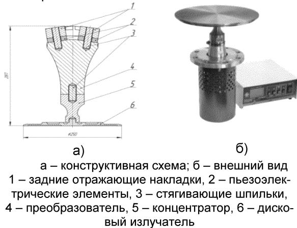
Рисунок 1 – УЗКС с двухполуволновым преобразователем и дисковым излучателем
