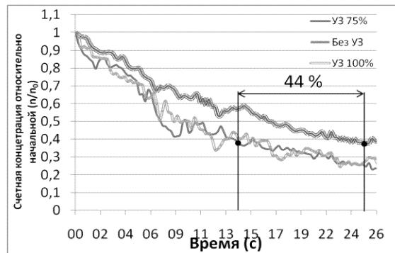
*Рисунок 6 – Зависимости относительной счётной концентрации частиц  $\text{SiO}_2$  от времени с воздушными потоками со скоростью 0,6 м/с.*
