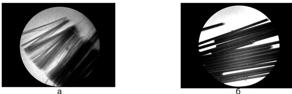
Рисунок 1 – Базальтовая фибра из тонкого (а) и грубого (б) волокна
