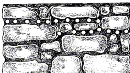
Рисунок 1 - Сверление отверстий в каменных конструкциях
