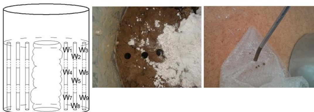
Рисунок 2 - Схема и процесс отбора проб грунта на установке для определения влажности в разных точках удаления от известковой сваи
