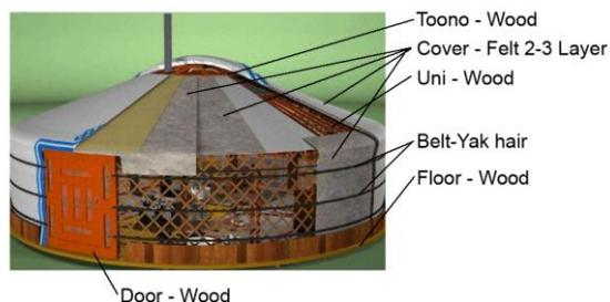
Рисунок 2 – Материалы, применяемые при сооружении юрты. Автор рисунка А. Бат-Од
