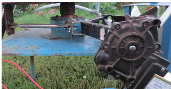
Рисунок 3 – Привод управлением положением плоскостью вакуумных трубок по азимуту: 1 – электрический двигатель, 2 – крепление двигателя к механическому домкрату, 3 – механический домкрат, 4 – крепление алюминиевого штока к домкрату, 5 – алюминиевый шток, 6 – крепление алюминиевого штока к вращающейся плоскости по азимуту, 7 – плоскость поворотного механизма по азимуту
