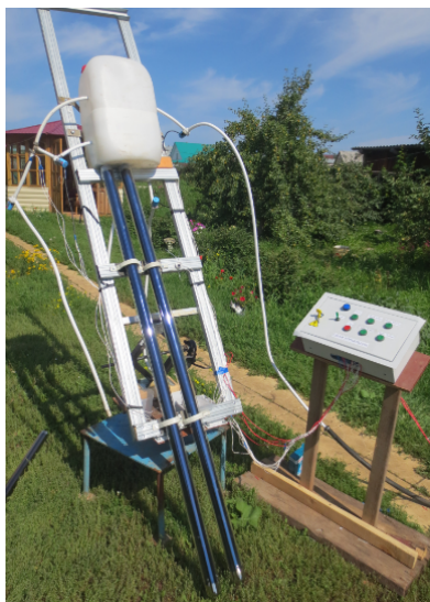
Рисунок 4 – Лабораторная солнечная опреснительная установка с устройством слежения 1 – плоскость поворотного механизма по азимуту, 2 – электрический домкрат для регулирования положения по азимуту, 3 – электрический домкрат для регулирования положения по высоте, 4 – шарнирный механизм, 5 – ось вращения по азимуту, 6 – алюминиевый шток, 7 – шарнирный механизм, 8 – клеммная коробка, 9 – опреснитель, 10 – вакуумные трубки солнечного коллектора
