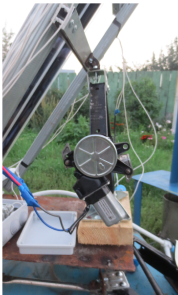
Рисунок 2 – Привод управления положением вакуумных трубок по высоте 1 – электрический двигатель, 2 – крепление двигателя к механическому домкрату, 3 – механический домкрат, 4 – крепление домкрата к плоскости вакуумных трубок, 5 – плоскость вакуумных трубок, 6 – шарнирный механизм, 7 – плоскость поворотного механизма по азимуту
