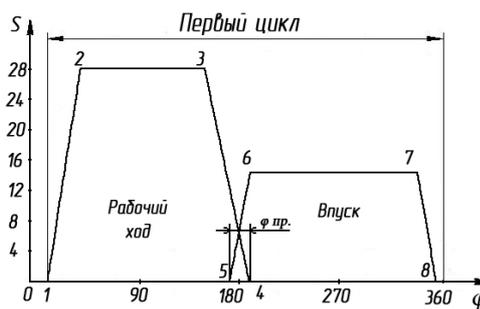
Рисунок 9 - Суммарный график фаз газораспределения (камера сгорания):
