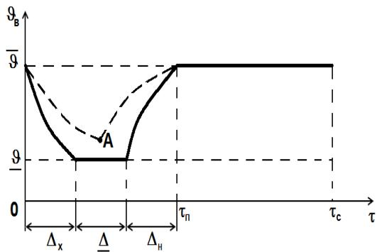
Рисунок 3 – График изменения температуры воздуха при прерывистом отоплении
