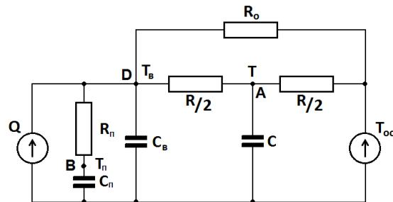
Рисунок 2 – Электрический аналог тепловой модели здания
