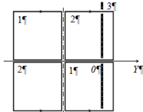
Рисунок 9 – Мультидифференциальный ВТП с квадратными обмотками над прорезью
