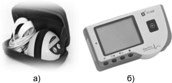
Рисунок 1 – Внешний вид индивидуальных электрокардиографов: а – домашний электрокардиограф CardioJet, б – карманный электрокардиограф АрмедРС-80В
