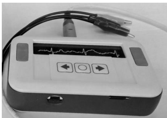
Рисунок 3 – Внешний вид разработанного прибора вместе с внешним кабелем для грудных отведений
