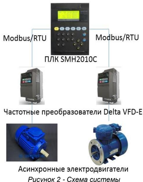
Рисунок 2 - Схема системы
