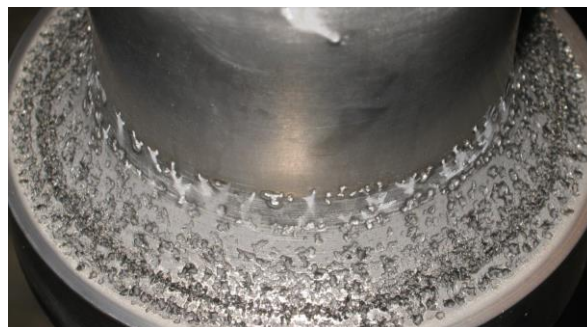
Рисунок 7 - Кавитационный износ поверхности ультразвукового инструмента
