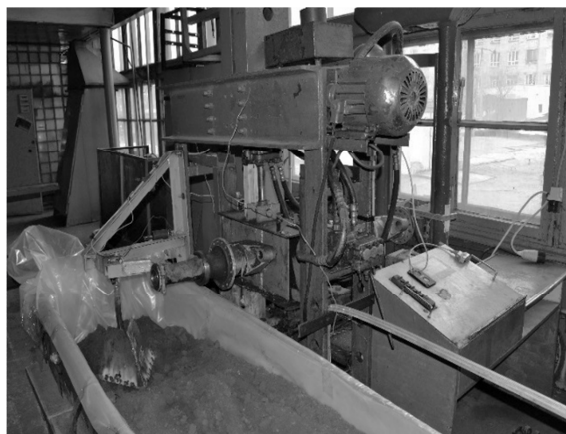
Рисунок 8 – Стендовый метод измерения тягового сопротивления почвообрабатывающего орудия в прямом почвенном канале
