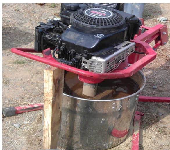
Рисунок 1 – Приготовление рабочего раствора в механоактиваторе на поле
