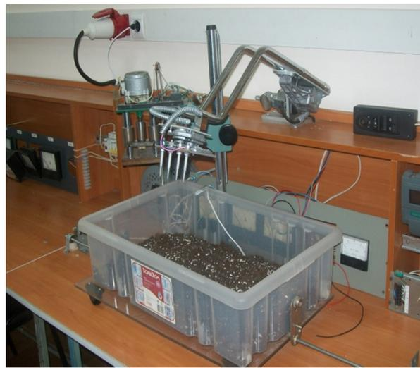
Рисунок 4 - Электротехнологический стенд для исследования зоны взаимодействия электромагнитного поля электродной системы с почвой, растениями, воздушной средой, конструктивными элементами: на переднем плане 4-х зондовый манипулятор для съема электрических характеристик растительных объектов и почвы; на заднем - манипулятор технологических электродов; внизу - контейнер с почвенно-растительными материалами на платформе, управляемой электроприводом
