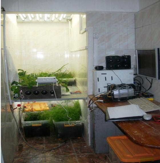
Рисунок 1 - Вегетационно-климатическая камера с информационно-измерительной системой для исследования реакционной способности растений, их активного повреждения под действием электромагнитных полей
