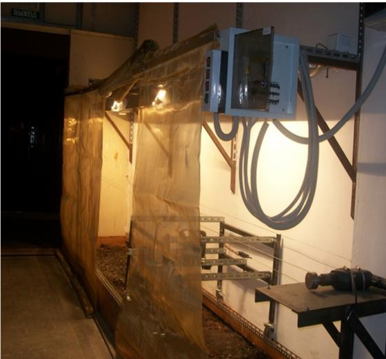
Рисунок 3 - Почвенный канал для исследования электродной системы мобильных электротехнологических установок: сверху – облучательная кассета с ультрафиолетовыми, инфракрасными, фитолампами и блоком управления, слева – экранирующие сетки, на переднем плане – электропривод шасси, в центре – шасси для позиционирования электродов, датчиков, приборов, аппаратуры с широким набором вариантов крепления электродов, как устройств и электродной системы в целом
