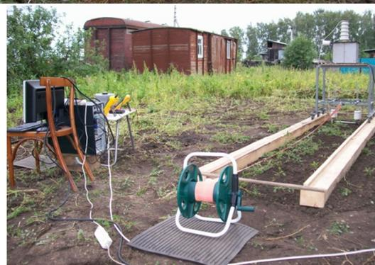
Рисунок 5 - Аппаратура для исследования электрического поля электродов (снизу первичный преобразователь для измерения электропроводности электролита и физическая модель электродной системы)
