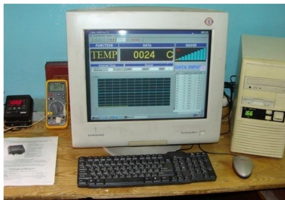
Рисунок 10 – Работа цифрового мультиметра MAS345 в качестве АЦП в составе информационно-измерительного блока (ИИБ)
