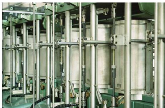
Рисунок 2 – Испытание образцов СПА на испытательных машинах ZSt-2/3
