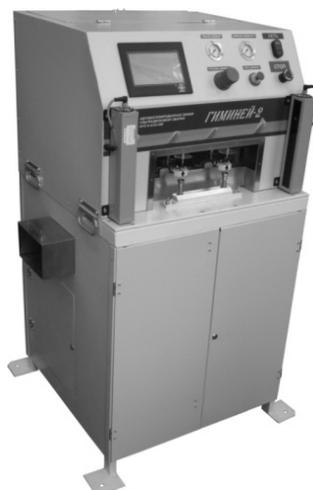
Рисунок 6 – Линия для соединения двух полусфер из термопластичных материалов
