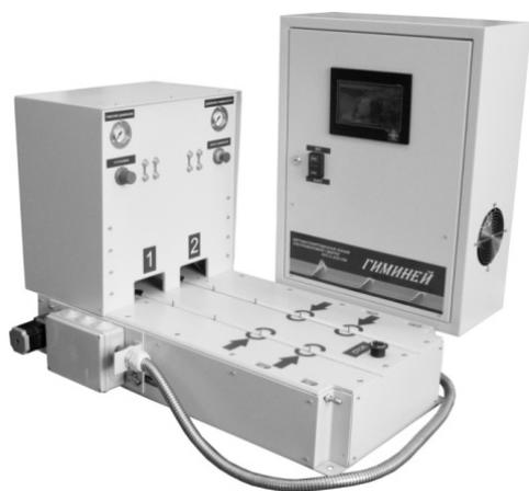
Рисунок 5 – Линия для соединения двух полусфер
