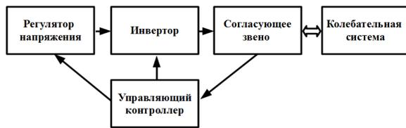
Рисунок 2 – Структурная схема ультразвукового генератора
