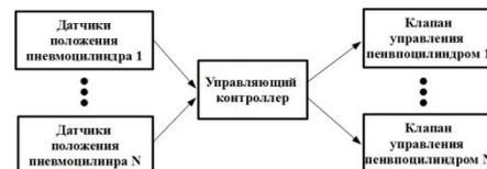
Рисунок 4 – Структурная схема блока управления системой прижима
