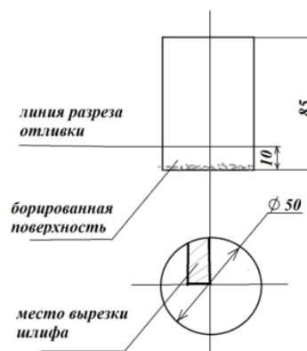
Рисунок 4 – Схема вырезки образца
