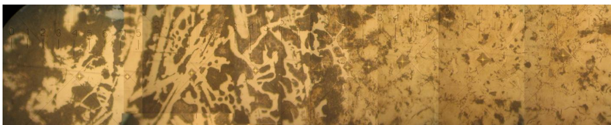
Рисунок 5 – Совмещенный снимок полученного борированного слоя
