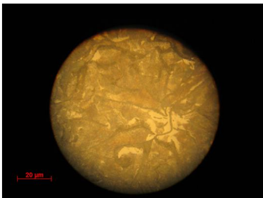
Рисунок 3 – Микроструктура металлической матрицы экспериментальных отливок после травления раствором азотной кислоты, x500
