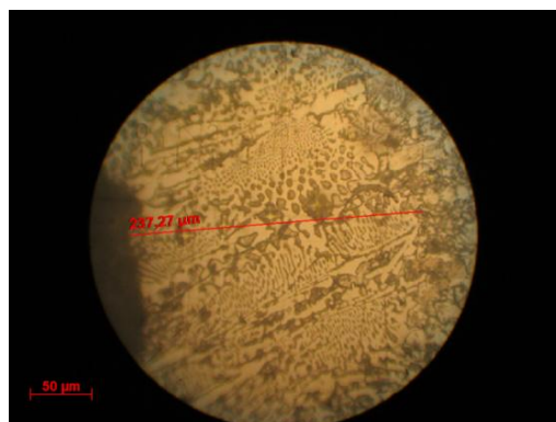
Рисунок 4 – Максимальная толщина борированного слоя 240 мкм на отливке массой m_{отлб} = 1,13 кг (максимальная температура)
