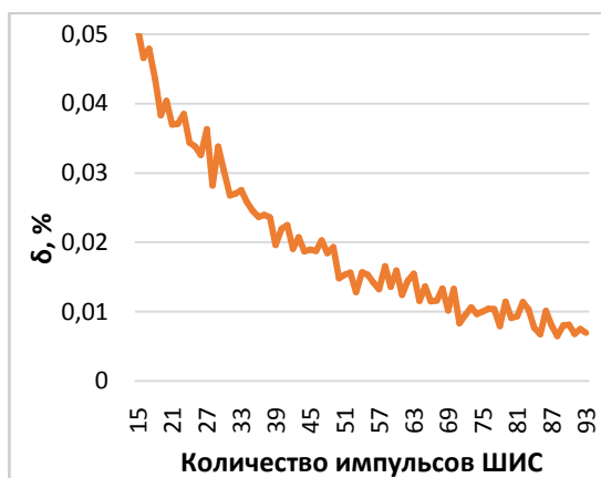
Рисунок 10 – Зависимость погрешности определения гармоники от количества периодов ШИС на периоде исследуемого сигнала.
