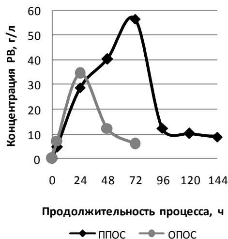
Рисунок 2 – Зависимости концентрации РВ от продолжительности процесса при одновременном и последовательном осахаривании-сбраживании
