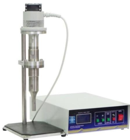
Рисунок 3 – Ультразвуковой аппарат для исследования кавитационной прочности материалов
