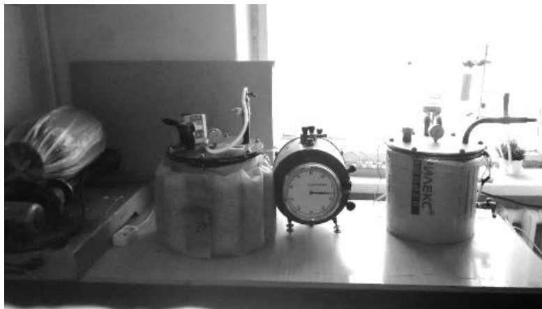
Рисунок 1 – Внешний вид опытной установки анаэробного сбраживания обезвоженного избыточного активного ила
