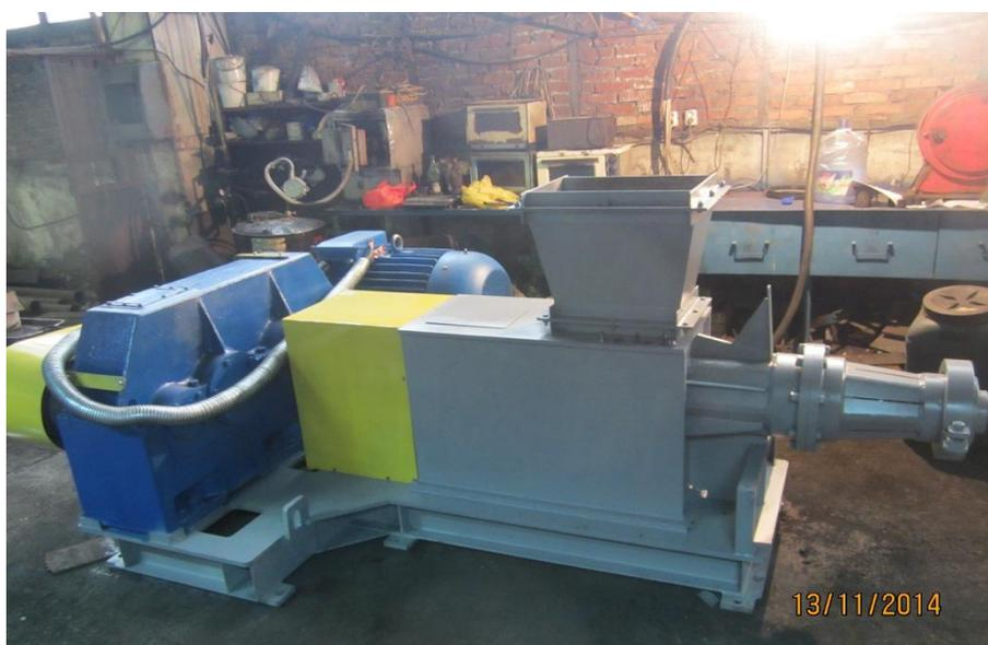
Рисунок 5 - Механоактиватор СИМ-1, производительностью до 15 т/час
