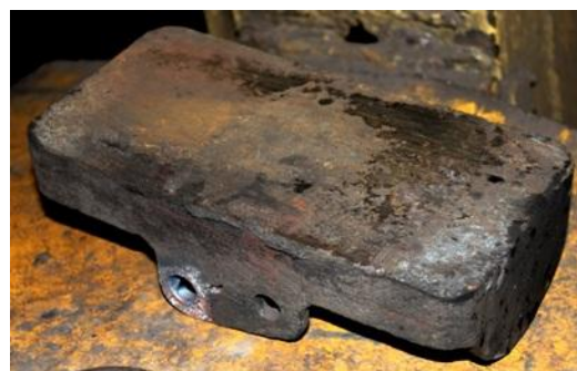
Рисунок 2 – Износ колпака скользуна
