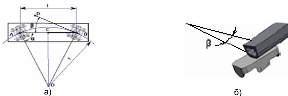
Рисунок 10 – Угловое расположение: а – кузова и тележки вагона; б – колпака и ответной части скользуна
