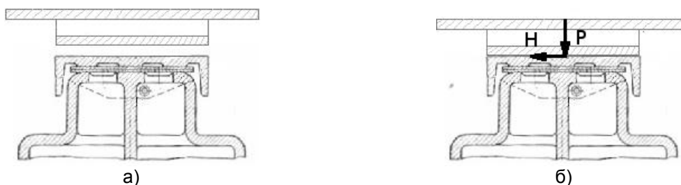
Рисунок 8 – Схема взаимодействия колпака скользя и опоры кузова вагона: а) – при уравновешенном состоянии кузова вагона, б) – при наклоне вагона под действием боковых сил
