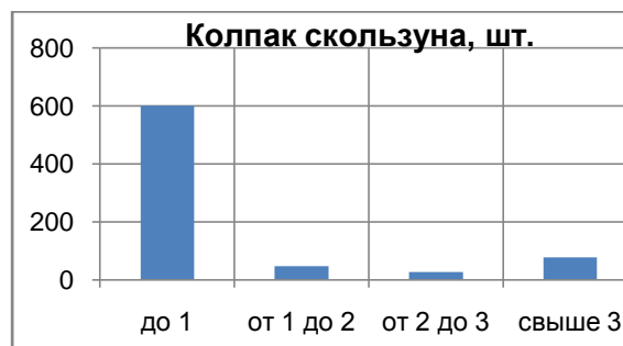
Рисунок 3 – Износ колпака скользуна
