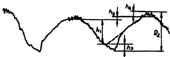
Рисунок 1 – Исходная схема для расчета высоты профиля шероховатости поверхности при механической обработке
