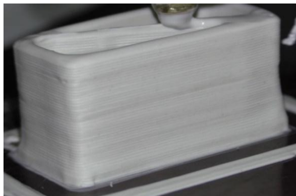
Рисунок 3 – Снимок процесса аддитивной печати образцов из термопластичных суспензий
