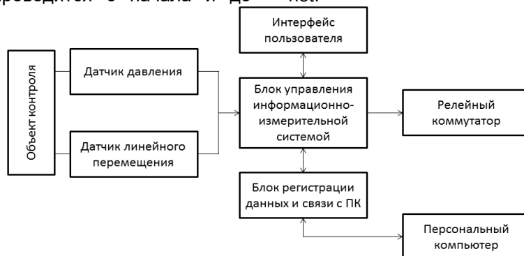
Рисунок 1 – Структурная схема измерительной системы для контроля запрессовки фланцев на стеклопластиковые трубы
