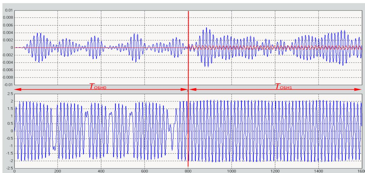
Рисунок 3 - Временная зависимость для входного сигнала (верхний график) и выходного сигнала обнаружителя (нижний график). Показаны интервалы времени при отсутствии полезного сигнала ( $T_{обн0}$ ) и при его наличии ( $T_{обн1}$ )
