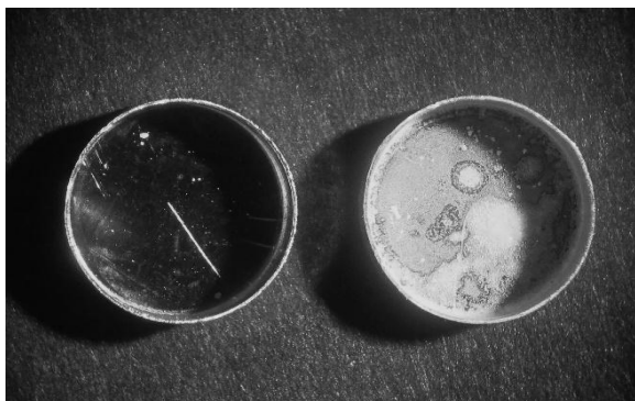
Рисунок 2 – Внешний вид алюминиевых тиглей после опыта: слева – опыт с АУ; справа – с ДНА.
