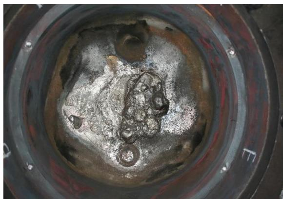
Рисунок 2 – Кориум в МДР после эксперимента INVECOR-4
