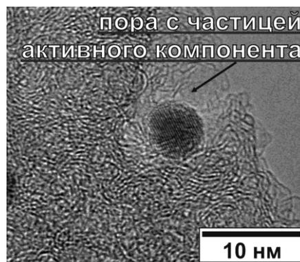
Рисунок – 6 Локализация кобальтовой частицы в поре 12%Со/ФАС катализатора.
