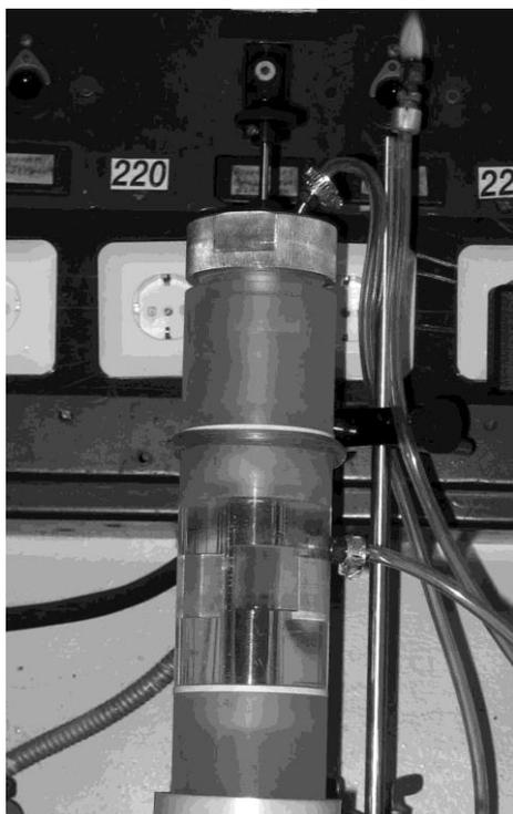
Рисунок 1 – Прототип генератора водорода с проточным трубчатым реактором, в котором реализован режим перемешивания катализатора за счет выделяющихся пузырьков газа.
