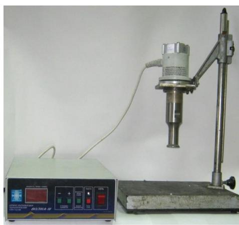
Рисунок 3 – Экспериментальный стенд для выявления зависимости объема зоны развитой кавитации от расстояния между излучателем и отражающей границей
