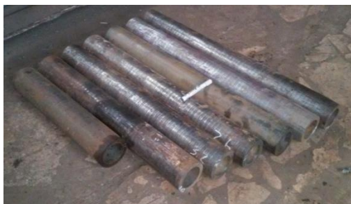
Рисунок 3 – Биметаллические трубы 37Г2Ф+08Х18Н10Т, полученные сваркой взрывом
