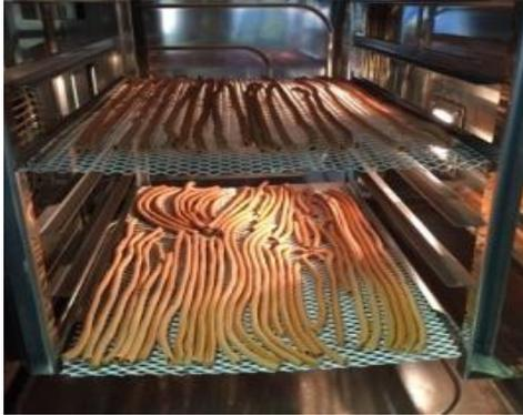
Рисунок 2 – Размещение полуфабрикатов при сушке в сушильной камере
