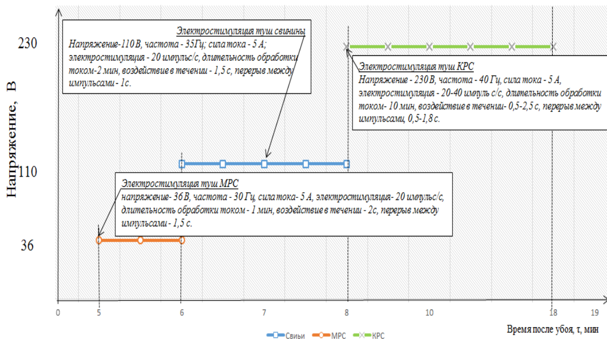
Рисунок 4 – Характеристика электрического тока, используемого для обработки туш различных видов животных
