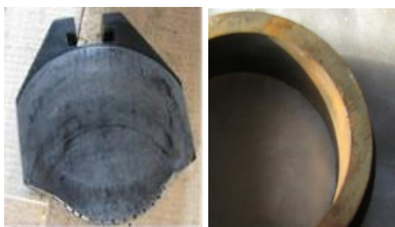
Рисунок 6 – Шибер и седло запорно-регулирующей задвижки МКТР после восемнадцати месяцев эксплуатации
