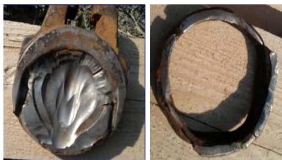
Рисунок 1 – Тыльная сторона клина и седло клиновой задвижки после шести месяцев эксплуатации в режиме регулирования
