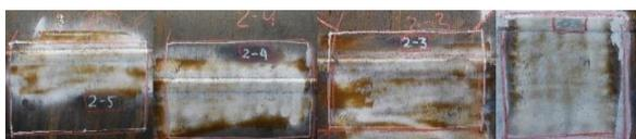
Рисунок 2 – Примеры образцов, содержащих трещины КРН, отобранные из газопровода
