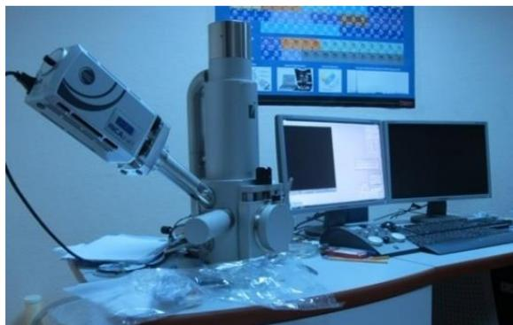
Рисунок 3 – Общий вид сканирующего электронного микроскопа TESCAN VEGA SBH Easy Probe
